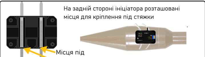
На задній стороні ініціатора розташовані місця для кріплення під стяжки
